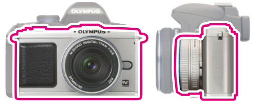
マイクロ一眼カメラ「OLYMPUS PEN E-P1」と従来の当社一眼レフカメラとの比較
