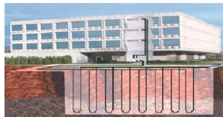
KeyMed社で採用された地熱システムの縦型クローズド・ループ(イメージ図)。ループを通じて、熱の放出や抽出を行い、冷暖房エネルギーの備蓄にあてている
