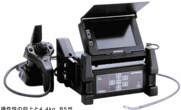
操作性の向上と4.4kg、B5サイズといった軽量化を押し進めたIPLEX MXシステム。
